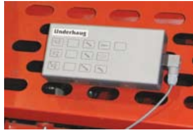
Boîtier de commande à partir de la table de triage de la mise à niveau du châssis, des rouleaux axiaux, ainsi que la vitesse du tapis de triage.
