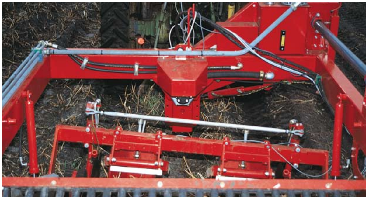
L'unité d'arrachage flottante unique de Underhaug épouse les contours du sol.
