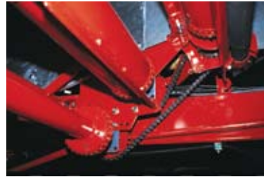
Le système d'entraînement du tapis principal à trois rouleaux facilite le remplacement du tapis afin de s'adapter aux différentes conditions de récolte.
