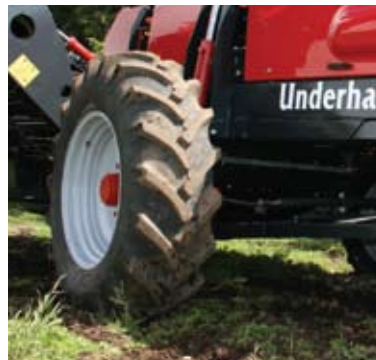
Des roues flottantes à direction hydraulique réduisent le tassement du sol et facilitent la manoeuvrabilité en conditions difficiles. D'autres options de roues sont disponibles.
