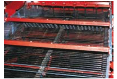
Tapis principal et deuxième tapis d'une largeur de 1650 mm pour une meilleure separation.
