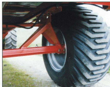
Stillbar sporvidde for optimal stabilitet.
