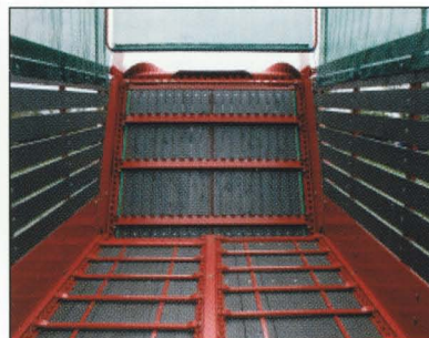
Dobbelt bunnbelte med 4 drivkjeder gir god driftssikkerhet.
